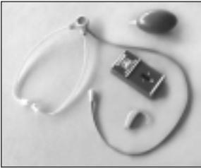
Stethoset, vérificateur de pile et bombe de séchage (ou « poire »)
